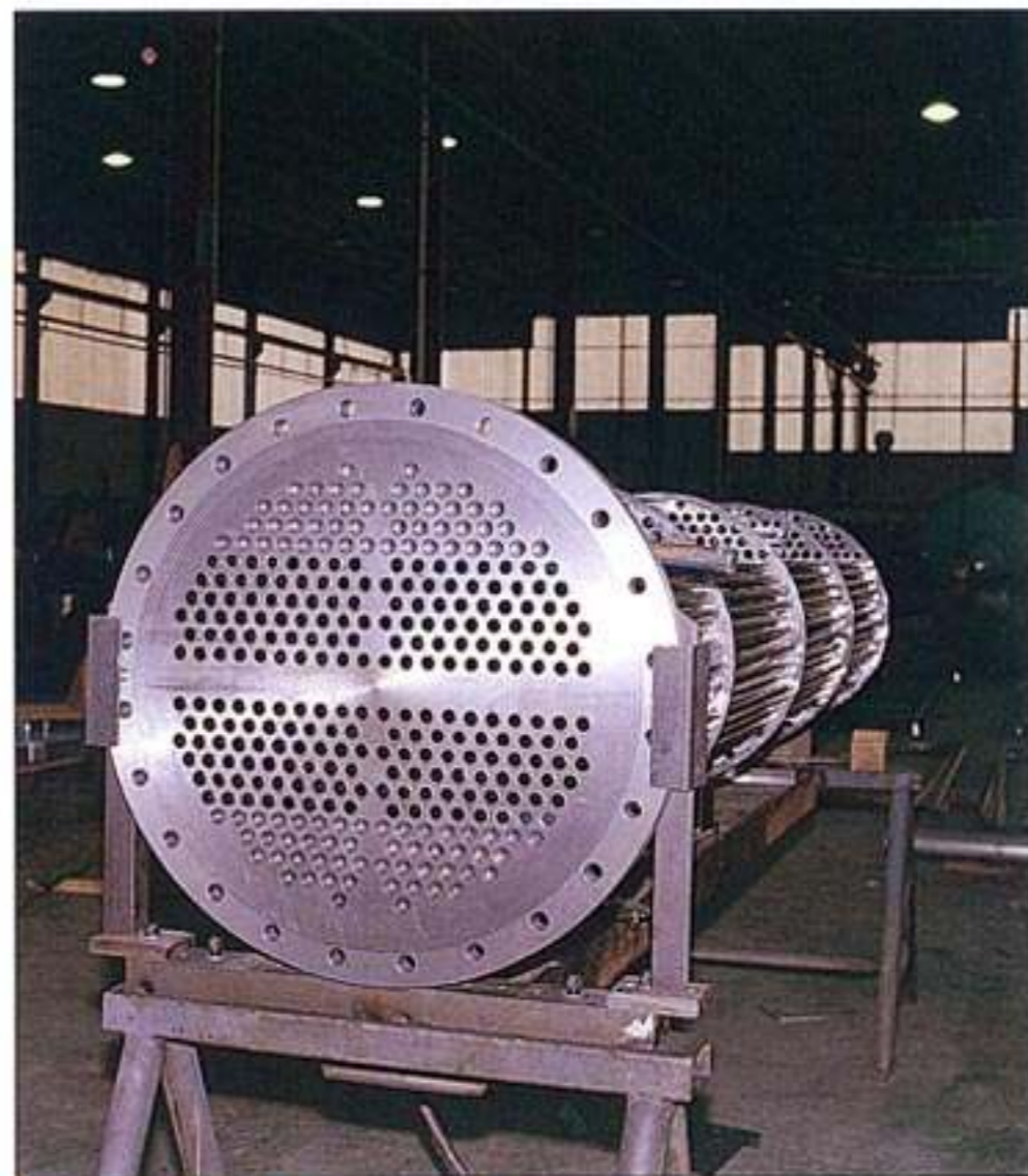
Fascio tubiero in costruzione
