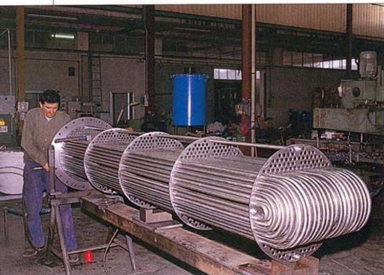
Fascio tubiero in costruzione
