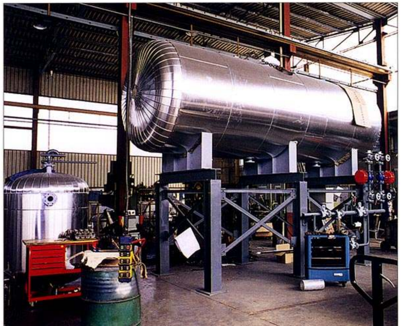
Degasatore in fase di montaggio
